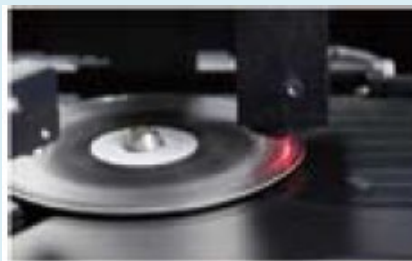
蛍光レーザーで測定 112アッセイ1.5分で測定
